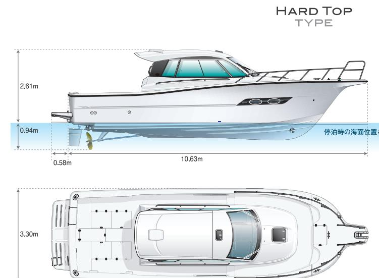
※吃水から水面の高さは、6LY2-WST搭載・軽荷時の値をしめす。
